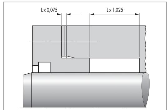
Fig. 54 DMS installation space example
